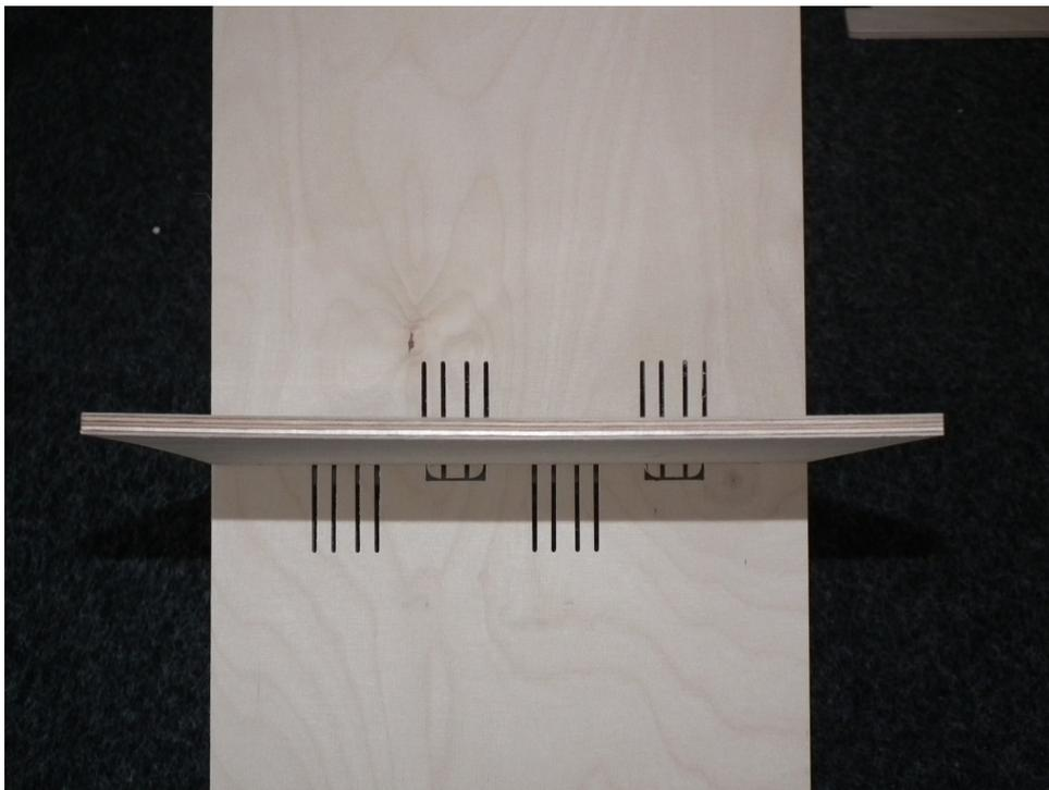
Das fertige Kreuz wird dann **vorsichtig** in den bereits fertigen und auf rechteckig ausgerichteten liegenden Rahmen eingeschoben.
