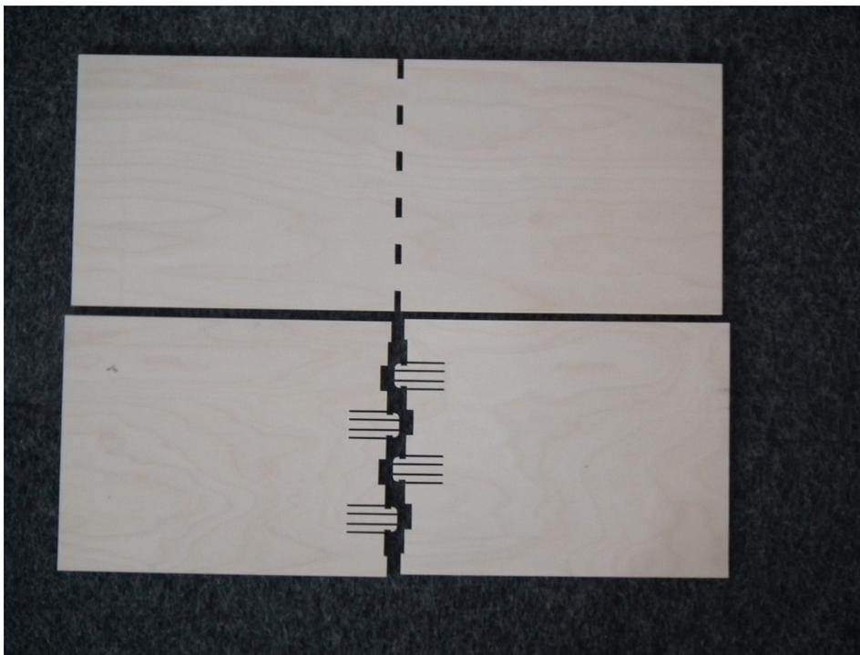
Die beiden kurzen Teile sind gleich und werden spiegelbildlich in das lange Teil von beiden Seiten durch die vorhandenen Löcher durchgesteckt.
